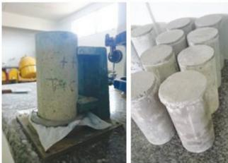
**Figura 11** – Ensaio de compressão axial.
