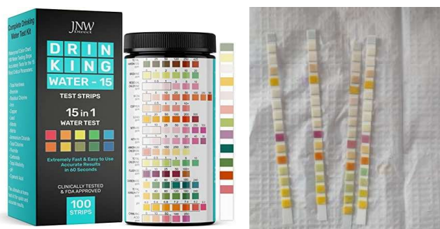
Figura 2 – Fitas reagentes utilizadas nos testes de potabilidade de água.
