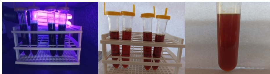
Figura 5 – amostras na luz uv; Figura 13 – Amostras antes da luz uv; Figura 14 – Amostra 2 com resultado positivo para coliformes totais
