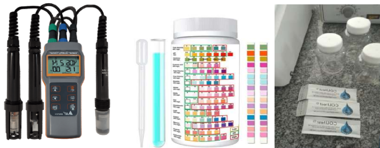
Figura 1 – Sonda utilizada nos testes in loco , ritas reagentes e colitest utilizado nas análises de potabilidade e microbiológicas, respectivamente.
